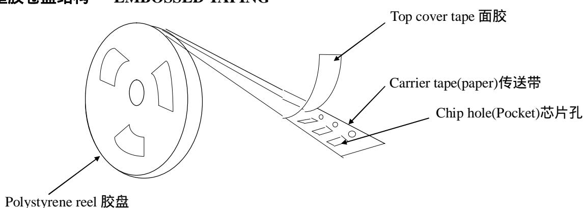
塑胶带尺寸结构(适合‘0805~1812’型产品)
